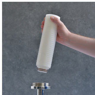
Abziehen der verbrauchten Filterkerze
