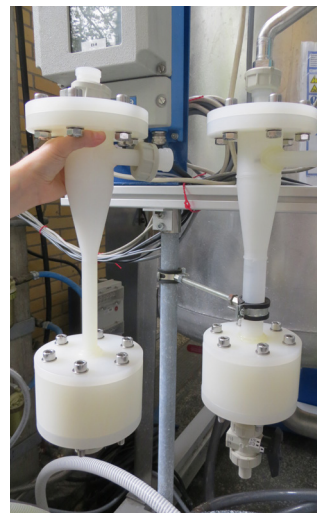
Abb. 4: Optimierter Zyklon WTDZA-PP-XE im Vergleich zu herkömmlichem WTDZA-PP. Optimierter Zyklon „XE“ (links) mit einem dünneren, schlankeren Design und höherer Abtrennleistung.
